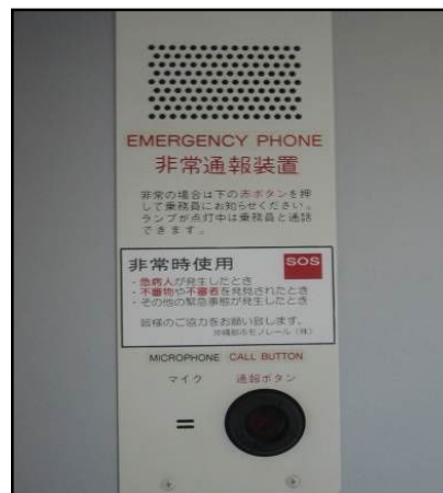
車両連結部 非常通報装置
